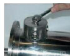
Ouvrir le couvercle du boîtier de raccordement avec un outil approprié.
