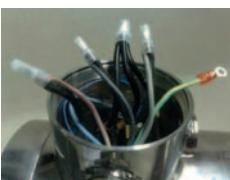
Motoranschlussenden und Kabelenden mit geeigneten Crimpverbindern gem. Anschlussbild schalten. Ebenso die Kaltleiter, bei Bedarf.
