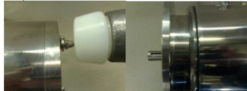
Attention : On ne doit en aucun cas essayer d'ouvrir le moteur en insérant un tournevis ou équivalent dans le joint de séparation entre la flasque et le carter.
