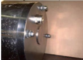
Bei extremen Bedingungen, z.B. sehr schneller Abkühlung betriebswarmer Motoren bei niedrigen Umgebungstemperaturen, hat die Wirkung der Belüftungselemente jedoch Grenzen – Taupunkt.
