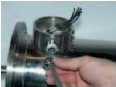
Introduire le câble de raccordement du moteur dans le boîtier de raccordement par le presse-étoupe. Veiller au montage et à la fixation soigneux du presse-étoupe afin de garantir le type de protection ; le cas échéant, utiliser de la pâte d'étanchéité pour le filetage.
