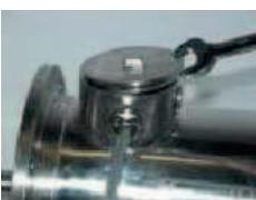
Anschlusskasten mit Deckel verschließen. Achtung, dass der O-Ring nicht beschädigt wird und der Deckel ohne zu verkanten fest angezogen ist.
