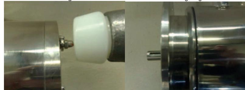
Achtung: Keinesfalls darf an der Trennfuge zwischen Schild und Gehäuse mit Schraubendreher o. ä. versucht werden, den Motor zu öffnen.
