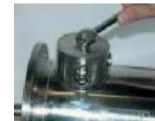
Deckel des Anschlusskastens mit geeignetem Werkzeug öffnen.
