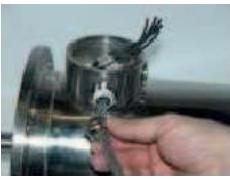
Motoranschlusskabel durch die Kabelverschraubung in den Anschusskasten führen. Auf sorgfältige Montage und Befestigung der Kabelverschraubung achten, um die Schutzart zu erhalten, ggf zusätzliche Dichtmasse für die Gewinde verwenden. Falls die zweite Kableinführung nicht benutzt wird, muss diese mit dem Blindverschluss aus Edelstahl sorgfältig verschlossen sein.
