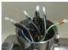
Monter des cosses à sertir appropriées sur les extrémités de raccordement du moteur et des câbles, conformément au schéma des connexions.
