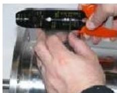
Dénuder avec soin les extrémités de raccordement du moteur et de câbles et préparer une gaine rétractable de diamètre et de longueur appropriés.
