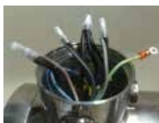
Motoranschlussenden und Kabelenden mit geeigneten Crimpverbindern gem. Anschlussbild schalten.
