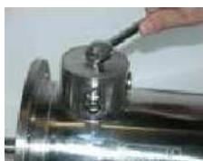
Deckel des Anschlusskastens mit geeignetem Werkzeug öffnen.
