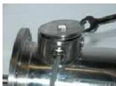
Fermer le couvercle du boîtier de raccordement. Veiller à ne pas endommager le joint torique et à serrer le couvercle sans le coincer.
