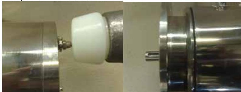
Attention : On ne doit en aucun cas essayer d'ouvrir le moteur en insérant un tournevis ou équivalent dans le joint de séparation entre la flasque et le carter.
