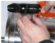
Die Motoranschlussenden und Kabelenden sorgfältig abisolieren und Schrumpfschlauch in passendem Durchmesser und Länge bereithalten.
