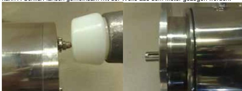
Achtung: Keinesfalls darf an der Trennfuge zwischen Schild und Gehäuse mit Schraubendreher o. ä. versucht werden, den Motor zu öffnen.
